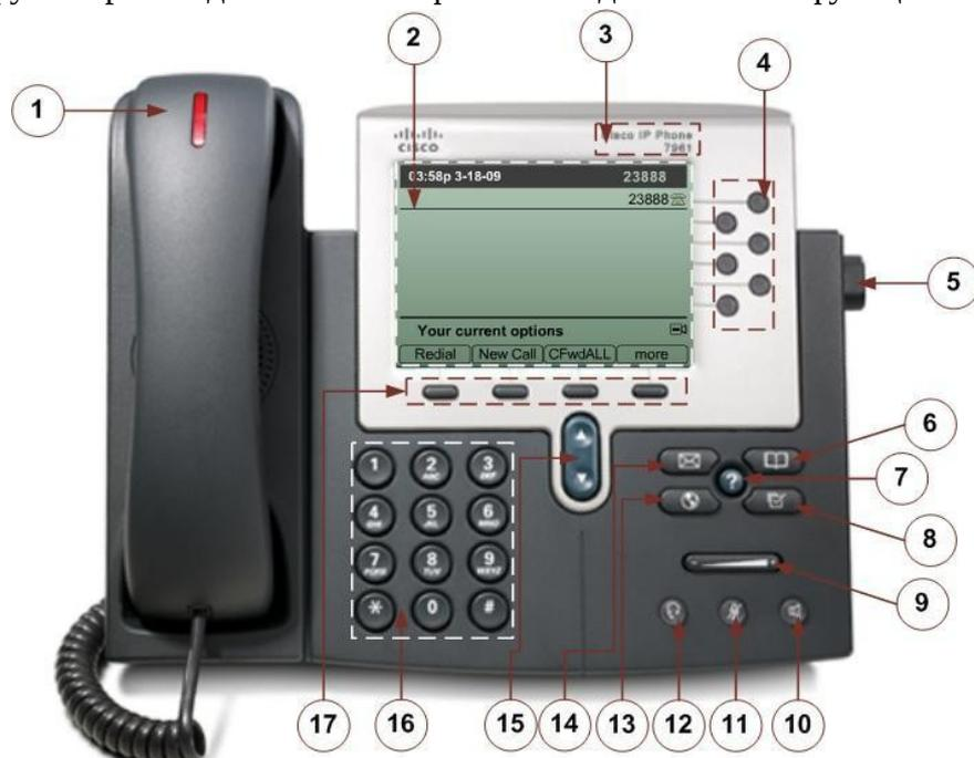
1 - трубка с индикатором. Работает как обычная трубка. Световая полоска в верхней части трубки мигает, когда телефон звонит. Ее можно настроить, чтобы она горела постоянно при получении сообщения голосовой почты. Чтобы получить дополнительную информацию о работе с трубкой, см. раздел "Регулировка громкости в телефонной трубке, громкоговорящей связи и гарнитуре".
